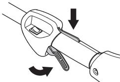
Проверьте, чтобы ручка газа в момент возвращения блокировочного рычага в исходное положение была блокирована на холостом ходу.
