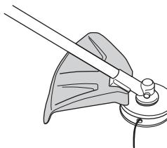
Проверьте, чтобы защита не была повреждена и чтобы на ней не было трещин. Замените защиту, если она была подвергнута удару или если на ней есть трещины.
