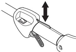
Проверьте, чтобы ручка газа и блокировочный рычаг перемещались свободно и чтобы возвратные пружины работали соответствующим образом.
